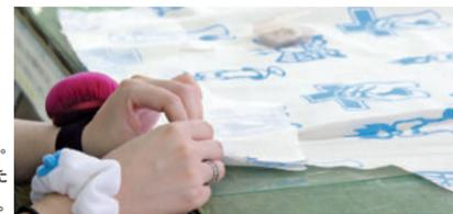
印を合わせて縫製準備。設計どおりに仕上げるため丁寧に印を合わせます。
